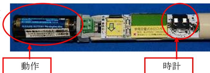
動作電池の電圧が十分高い場合は、内部時計は動作電池で動いており、時計電池を消耗しません
