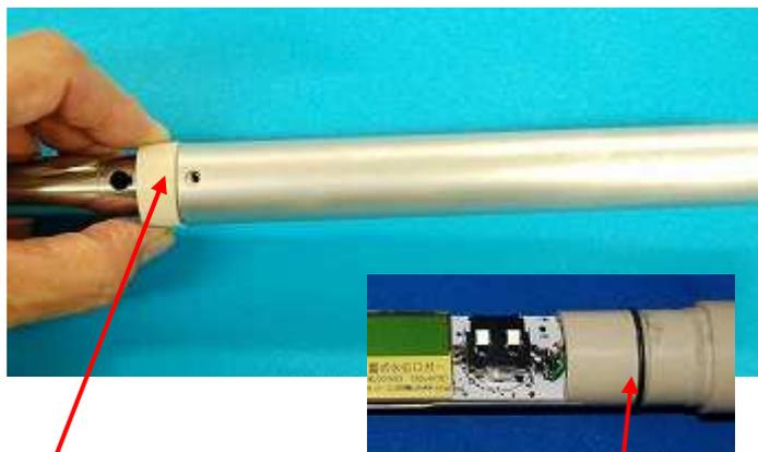
首樹脂とステン管をしっかり押さえながら、ログ部トップカバー（アルミ管）を回しながら外します
