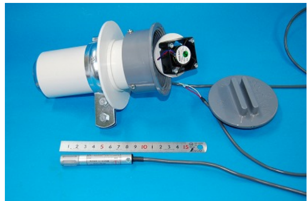
強制通風筒と温湿度センサー
